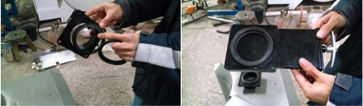
**2.4** Se colocan los tornillos de la válvula de adentro hacia afuera, no antes sin haberle aplicado una capa de silicón al tornillo, cuya función será prevenir fugas.
