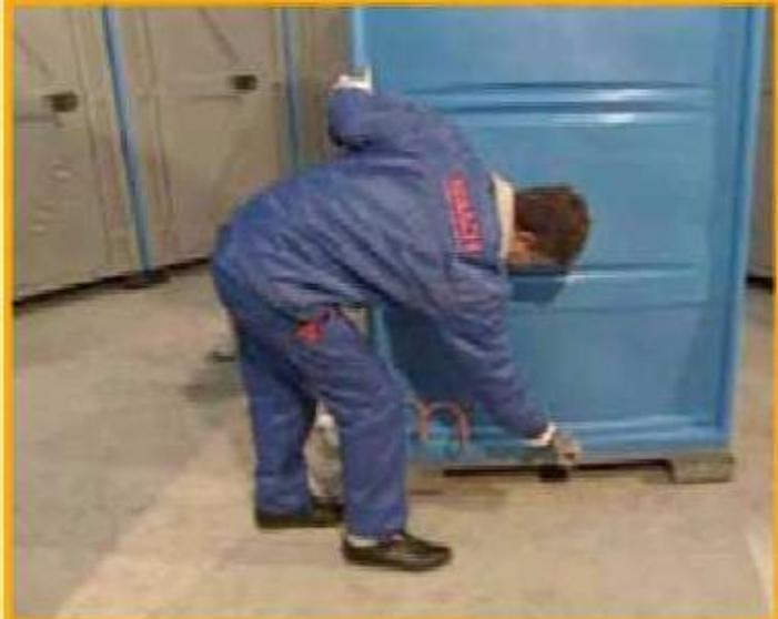
**1.10 Pasar a la segunda pared lateral y fijarlo con un remache en el medio, un remache por encima y por debajo del remache.**
